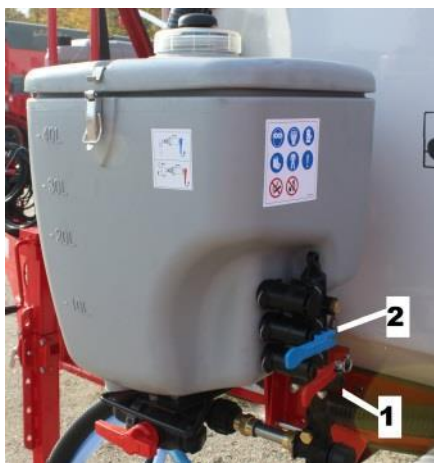
Rys. 14. Dźwignia 1 zaworu wypłukującego i pokrętło 2 zaworu myjki rozwadniacza.
