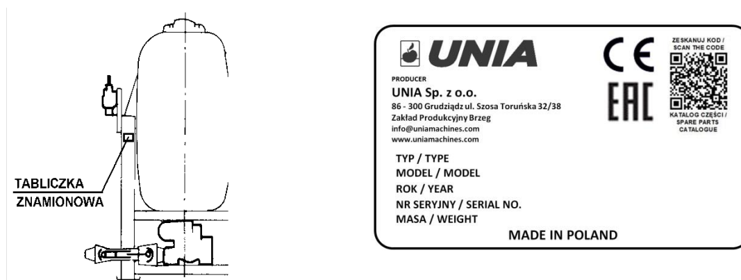
Rys. 1 Miejsce mocowania tabliczki znamionowej: 1- tabliczka znamionowa
