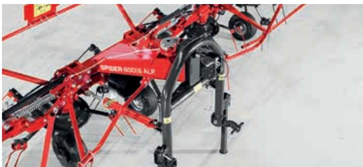
Zaczepek skrętny (SPIDER 400|4 ALP, 600|6 ALP) poprawia sterowność i podążanie za ciągnikiem.
