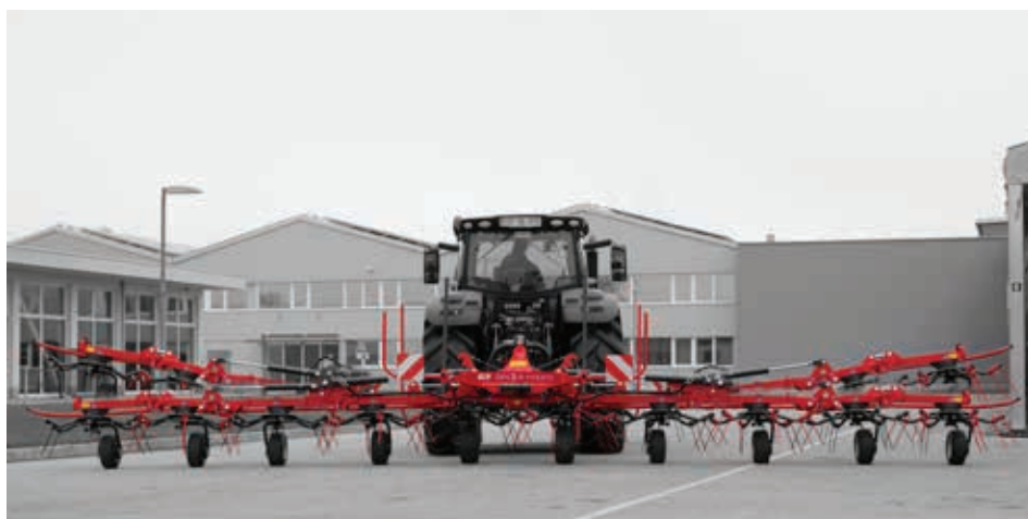
Segmentowane rotory pozwalają na idealne dostosowanie do gruntu nawet na trudnym terenie.
