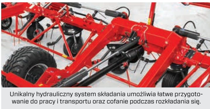
Regulowany łącznik belki zaczepowej z ramą transportową do maksymalnej prędkości 40 km/h.
