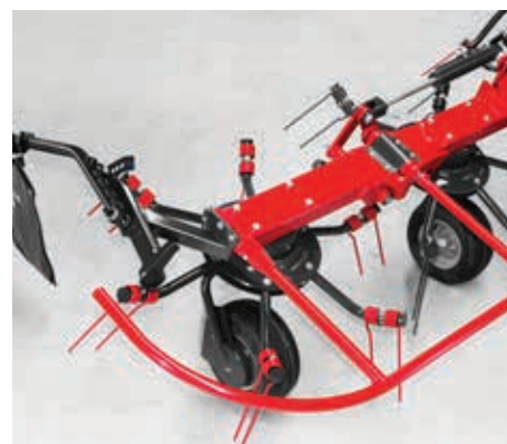
Połączone poręcze zabezpieczające zapewniają maszynie dodatkową stabilność i wytrzymałość.
