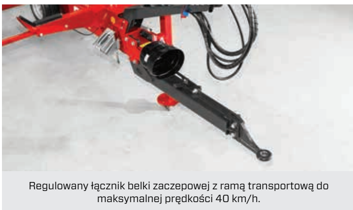
Zaczepek skrętny z hydropneumatycznymi stabilizatorami zapewnia stabilne podążanie za ciągnikiem.
