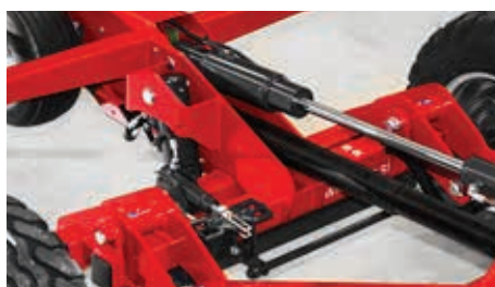
Opatentowana regulacja hydrauliczna kąta rotora (opcjonalna) od 13° do 19° lub od 15° do 21° na potrzeby równomiernego rozkładu pokosa.
