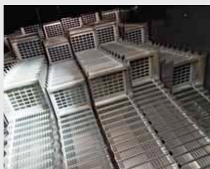
W przypadku zbioru kukurydzy na ziarno, wzmocniliśmy pierwszy stopień wytrząsaczy.
