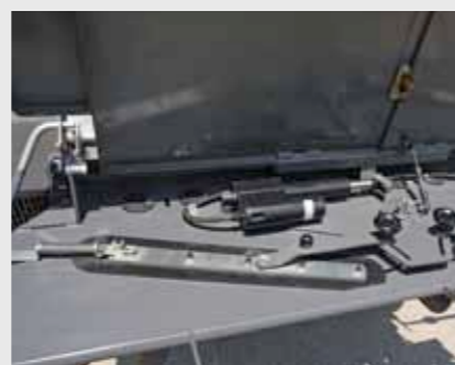
Kierownice rozdrabniacza słomy regulowane elektrycznie są dostępne w wyposażeniu opcjonalnym. Przestawienie umożliwia równomierne rozłożenie rozdrobnionej słomy na całej szerokości pracy kombajnu zbożowego.
