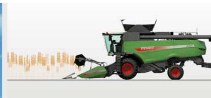
Constant Flow automatycznie kontroluje prędkość jazdy kombajnu Fendt w zależności od ilości podawanego do młocarni materiału.
