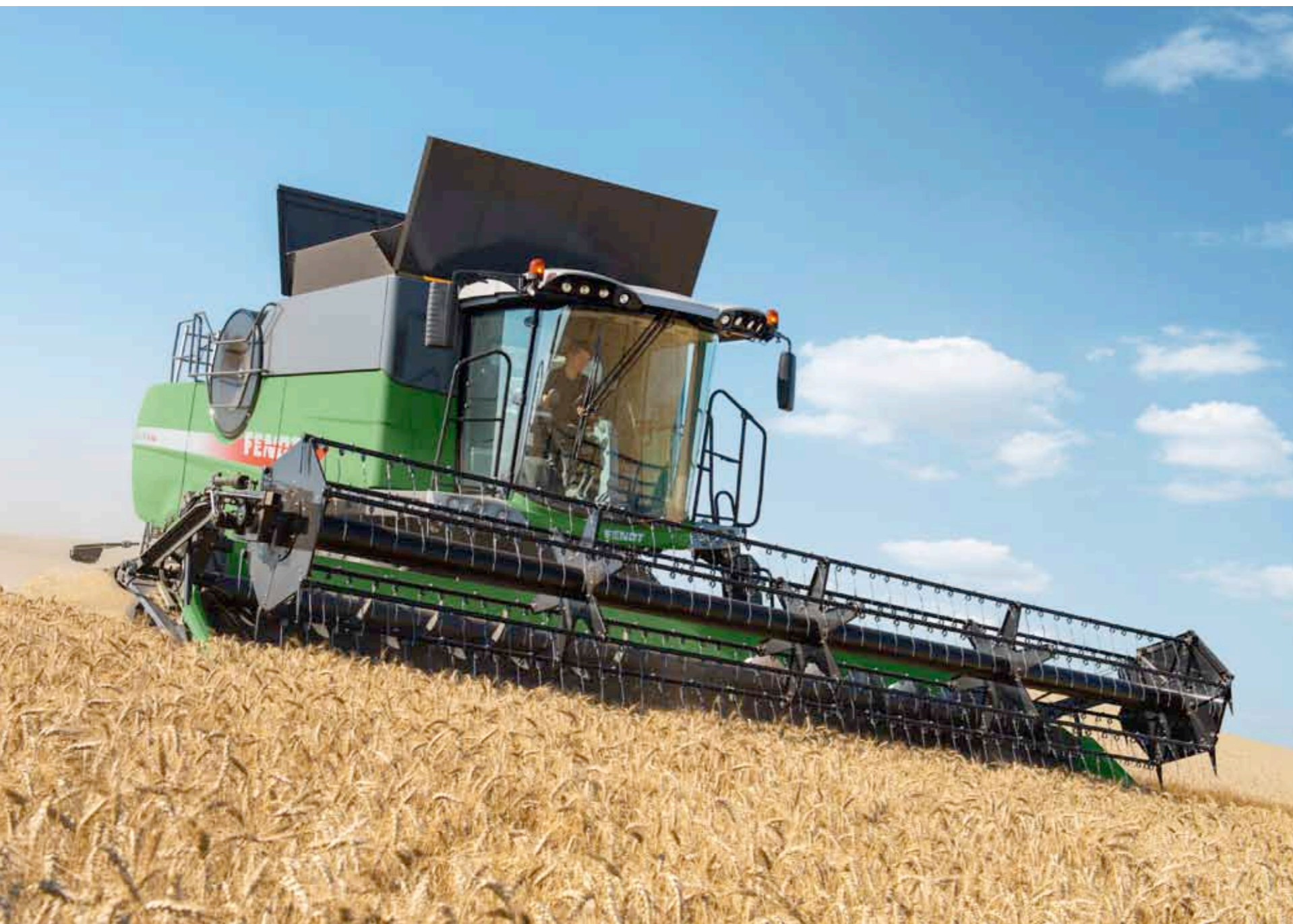
Constant Flow automatycznie kontroluje prędkość jazdy kombajnu Fendt w zależności od ilości podawanego do młocarni materiału.
