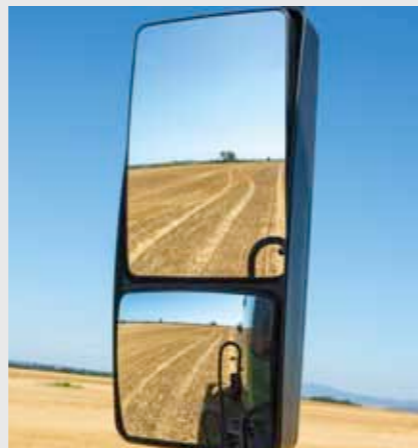
Dwuczęściowe szerokokątne lusterko zapewnia doskonałe pole widzenia na boki kombajnu
