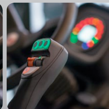
Czułe i precyzyjne sterowanie maszyną oraz osprzętem dzięki hydraulicznie sterowanemu joystickowi.
