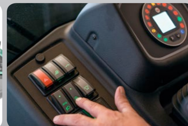
Wszystko pod kontrolą również w nocy: podświetlone przełączniki oraz intuicyjne i przemyślane miejsce pracy operatora.
