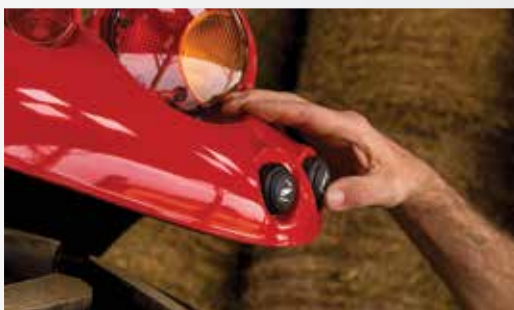
Przyciski obsługowe tylnego podnośnika umieszczone na błotnikach
