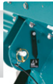
Strzałka ustawienia w poziome i pod kątem dla rozsiewu późnego
