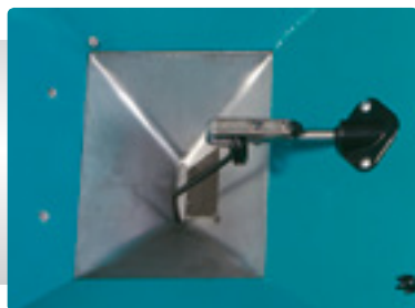
Denko zsypane ze stali nierdzewnej i sprężyste mieszadło
