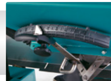
Nowe, czytelne skale dla ustawienia dawki rozsiewu co do kilograma
