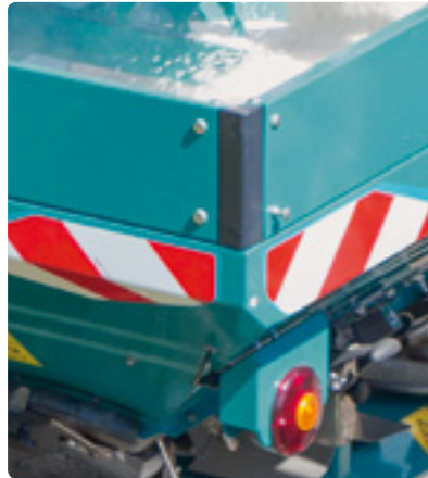
Nadstawka zbiornika z prostymi ściankami (opcja)
