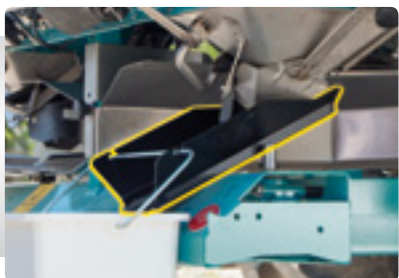
Rynienka spustowa, wykorzystywana również do próby dawki rozsiewu
