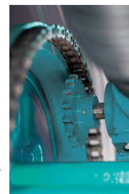
Podłogowy podajnik taśmowy z napędem od koła jezdnego z wbudowanym układem załączania napędu (DPA) (seryjnie)
