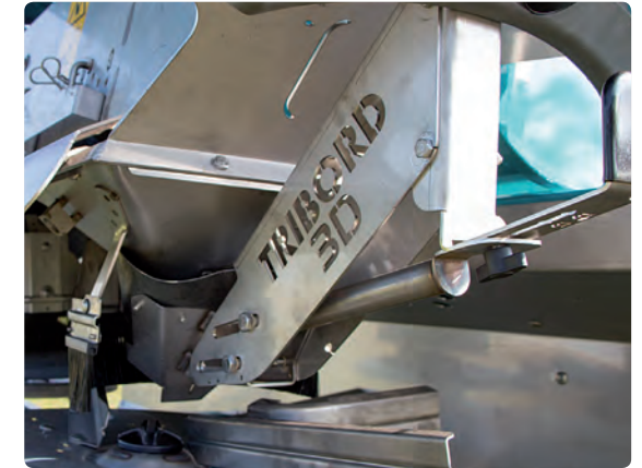
TRIBORD 3D – rozstaw graniczny przestawiany ręcznie (seryjnie) lub elektrycznie z kabiny ciągnika (opcja)
