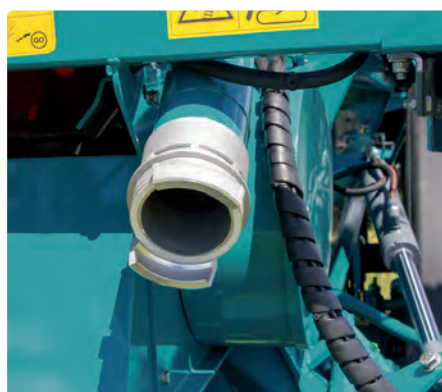
Rura do napełniania pneumatycznego belki napędzanej mechanicznie (opcja) lub belki napędzanej hydraulicznie (seryjnie)
