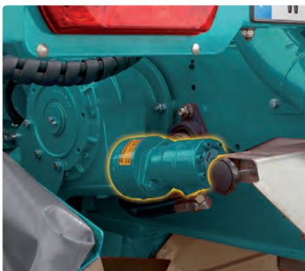
Hydrauliczne opróżnianie zbiornika z resztek produktu na końcu pola (opcja)
