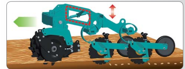
Rama nośna opuszczona : do wysiewu na dużą głębokość (np. bobiku).
