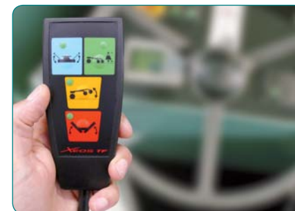
Selektor elektro-hydrauliczny dla wersji na ramie składanej (opcja w przypadku znaczników przejazdów wyposażonych w niewystarczającą ilość rozdzielaczy hydraulicznych).
