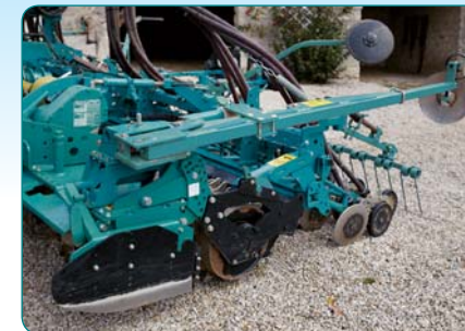
Znaczniki przejazdów składane hydraulicznie, znaczące ślad « na środek » maszyny, zamontowane na bronie wirnikowej, dysponują zabezpieczeniem biernym (ściana śruba) i sprężynowym zabezpieczeniem aktywnym.
