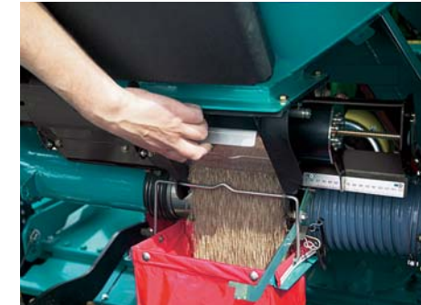
Do przeprowadzenia próby kręconej dawki wysiewu odbywa się za pomocą korby lub elektrycznie ; opróżnianie zbiornika jest « ekspresowe ».
