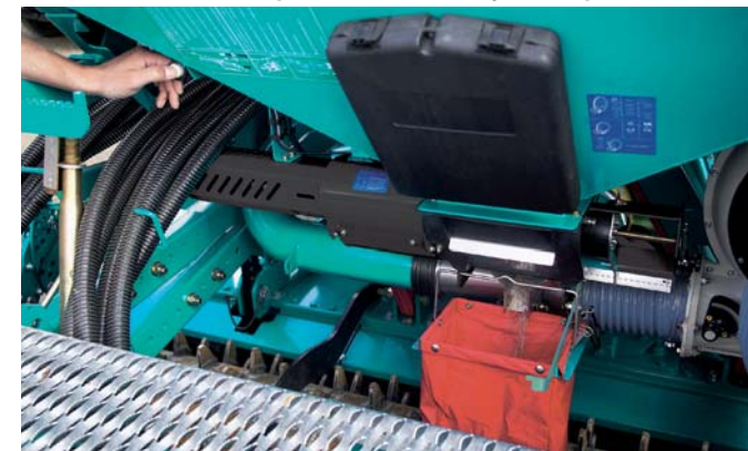
Dozownik SULKY umożliwia osiągnięcie wysokiej wydajności podczas pracy w polu i w czasie przeprowadzania ustawień. Do próby kręconej niczego nie trzeba demontować, wszystkie ustawienia znajdują się w pobliżu dozownika.
