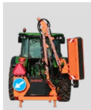
Pozycja transportowa - widoczny zderzak tylny ze światłami.
