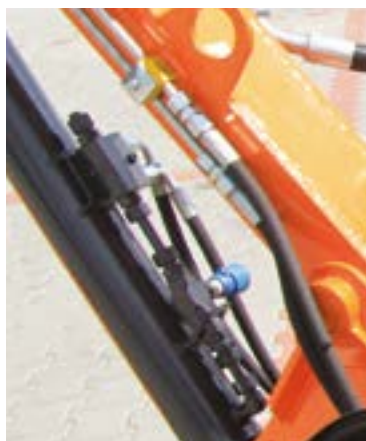
Rygiel hydrauliczny na głównym cylindrze wraz z zaworem dławiącym nastawnym.
