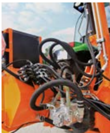
Zasilający układ hydrauliczny wraz z rozdzielaczem - wydajny i wytrzymały.
