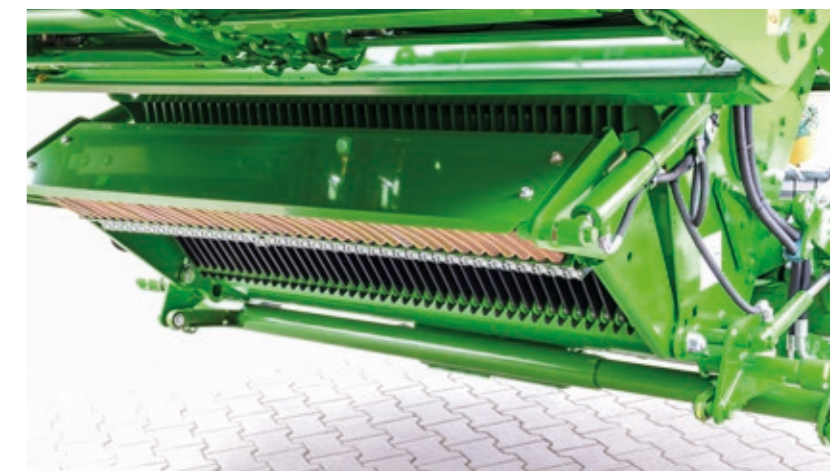
53 noże w jednym rzędzie, 34 mm długość cięcia Ebene
