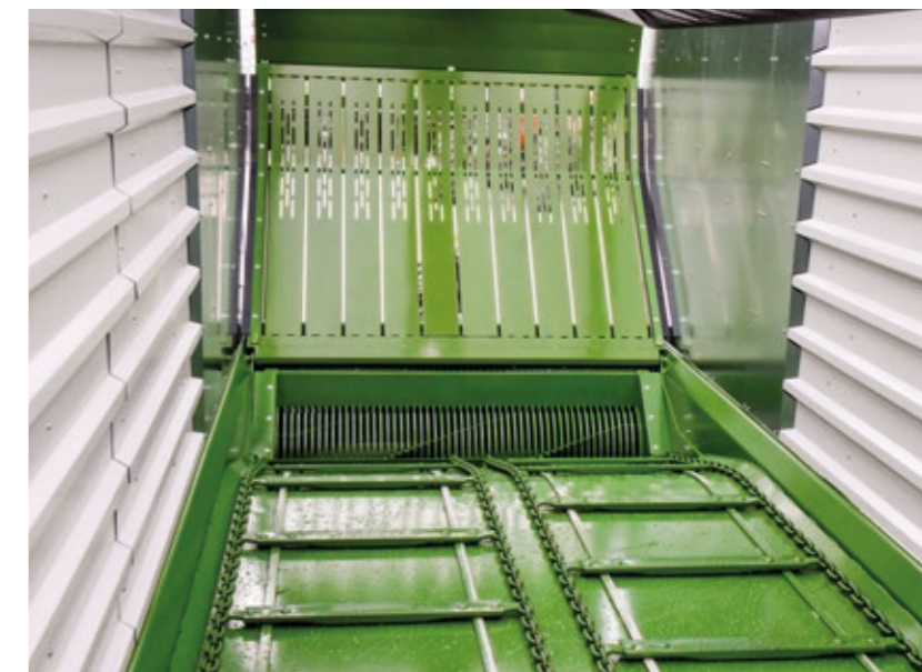
Obniżona podłoga, 4 łańcuchy (każdy 14 x 50 mm, 25 t/łańcuch)
