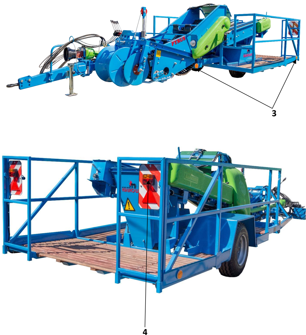
Rys. 11. Rozmieszczenie świateł na Pyrusie II.
