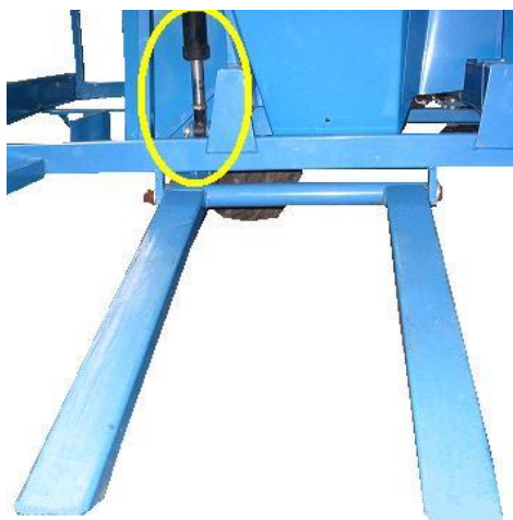
Rys. 8. Widły do skrzyniopalet z regulacją hydrauliczną.
