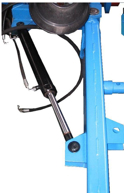
Rys. 6. Dyszel z silownikiem hydraulicznym
