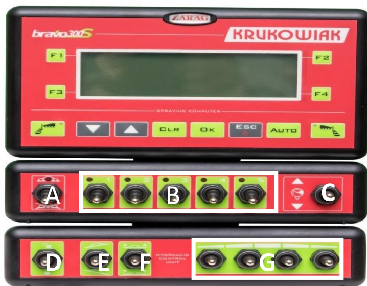
Rysunek 22. Panel sterowania komputera rolniczego BRAVO 300s.
