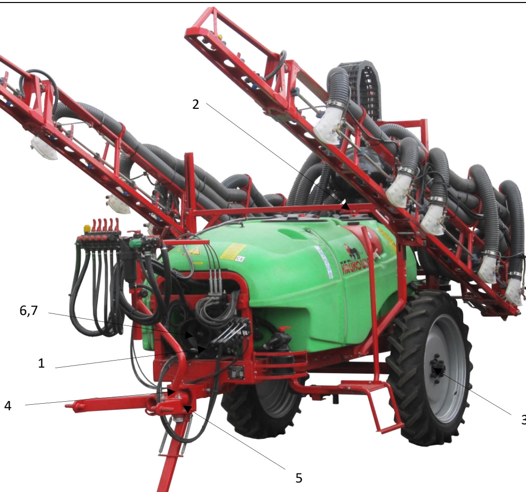
Rysunek 27. Punkty smarowania opryskiwacza P154/2.
