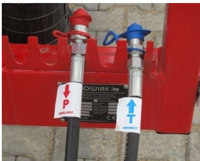
Rysunek 2 Przewody hydrauliczne umocowane prawidłowo.
