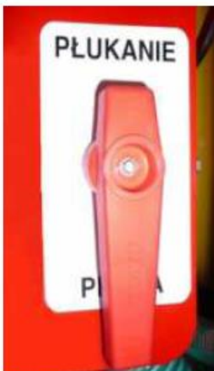
Rys. 30 Zawór kulowy trójdrożowy 2" (na ssaniu pompy) – Plus 2000 i 2500
