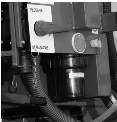
Rys. 11. Widok filtra ssawnego
