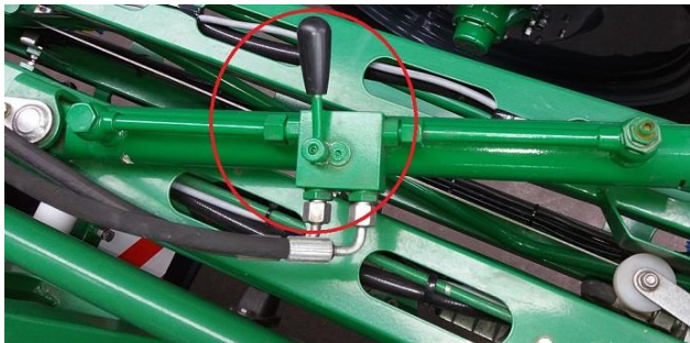
Rys. 23 Dźwignia zamka na siłowniku rozkładania ostatniego skrzydła.
