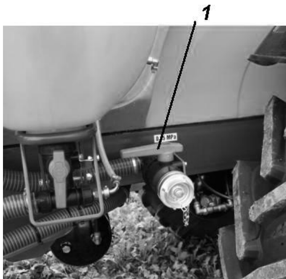
Rys. 15. Zawór przyłącza hydrantowego
