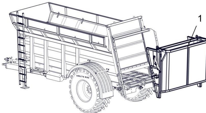
Rys. 19 – Adapter objętościowy , 1 - hydrauliczna klapa tylna
