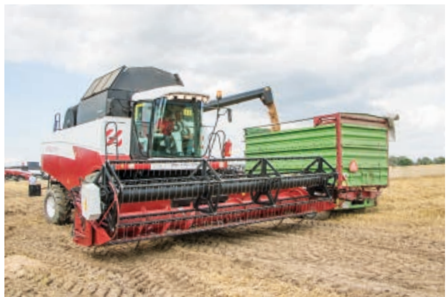
Acros 595 Plus ma zbiornik o pojemności 9000 l, a prędkość wyładunku jest określona na 90 l/s.
