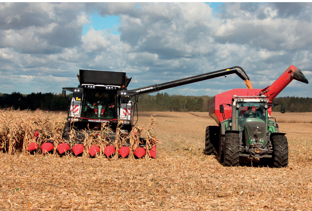
Oczyszczone ziarno trafia do zbiornika o pojemności 12.300 litrów. Tak duża pojemność pozwala zmniejszyć ilość cykli rozładowywania. Prędkość wyładunku wynosi 120 litrów na sek., co sprawia, że zbiornik jest opróżniany w ciągu 2 minut.
