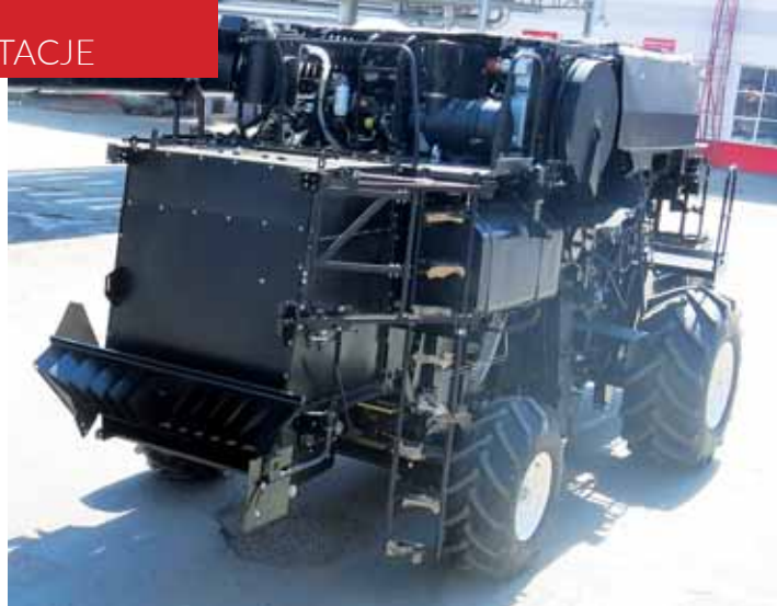
Po zmontowaniu każdy kombajn przechodzi szereg testów na wydzielonym stanowisku. Ponadto odbywa się jazda testowa na dystansie kilku kilometrów. Podczas tych prób maszyna jest goła – nie ma żadnej osłony.
