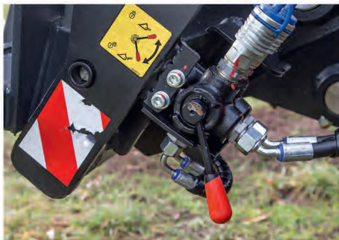
Plusem ocenianego modelu jest hydrauliczna blokada, co ułatwia częstą wymianę osprzętu.
