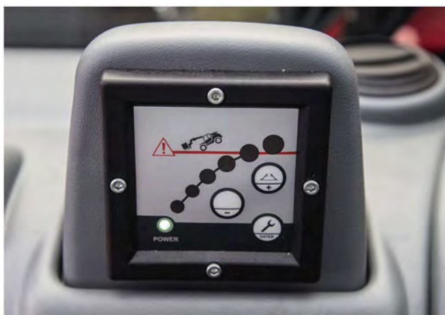
Centralnie za kolumną kierowniczą ulokowano wskaźnik obciążenia wysięgnika teleskopowego.
