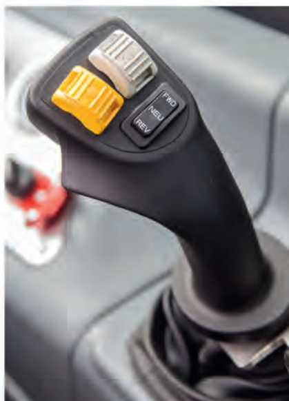
Za pomocą joysticka wykonujemy wszystkie ruchy wysięgnikiem...
