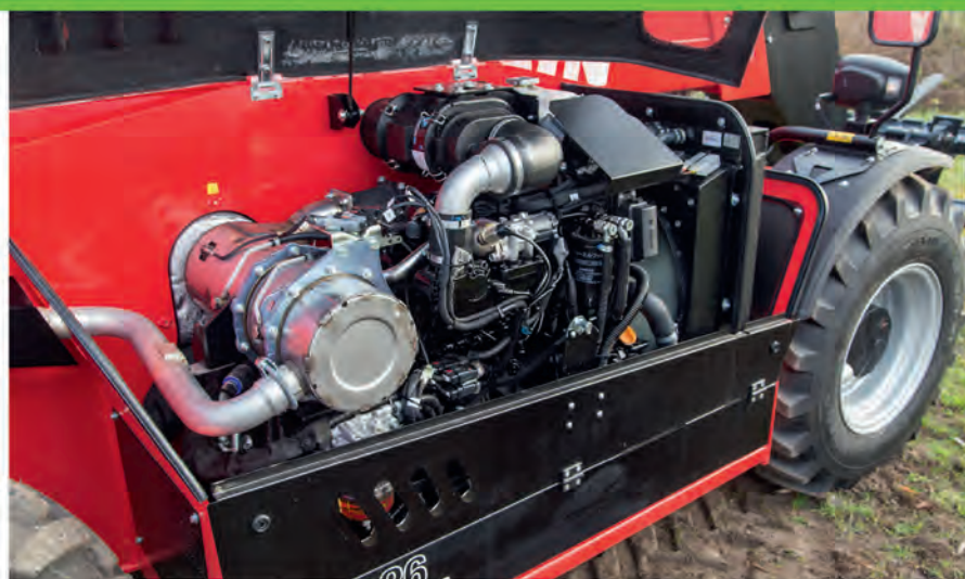
Ładowarka wyposażona jest w wolnossący silnik marki Yanmar, który z pojemności 2,2 litra rozwija moc 70 KM. Obsługa silnika jest komfortowa.
