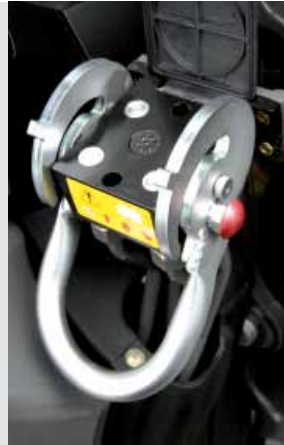
Wielozłącze umożliwia podłączenie wszystkich przewodów hydraulicznych i elektrycznych za jednym razem, nawet jeśli są one pod ciśnieniem od strony ładowacza czołowego.
