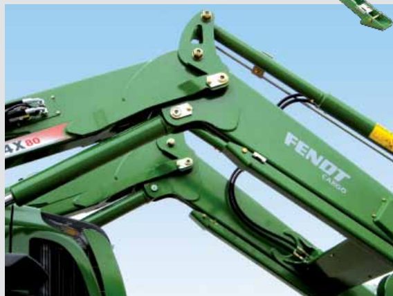
Równoległobok mechaniczny: kompaktowa budowa dzięki kinematyce Z.
