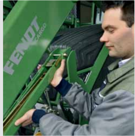
Podpory postojowe z automatyczną regulacją posiadają zwartą budowę i są zintegrowane z ramą ładowacza.
