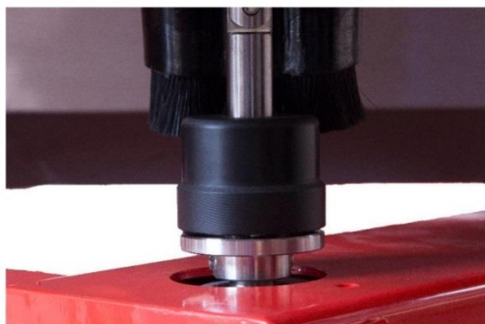
rys. 4.28 Test przepływu: mocowanie wału mieszadła
