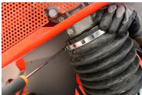
rys. 4.13 Montaż wału kardana - 2
