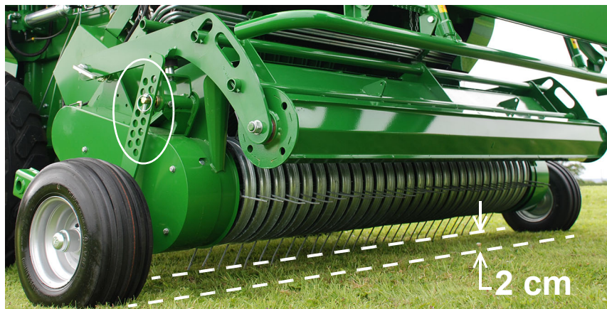
Regulacja wysokości motowidła zbieraka
