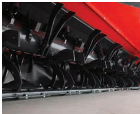
Elastyczne stalowe palce uszkodzają łamią i ścierają łodygi, umożliwiając szybkie suszenie.
