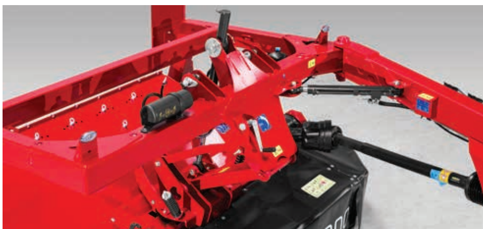
Precyzyjny układ kopiowania terenu listwy tnącej poprzez system zawieszenia S-FLOW.
