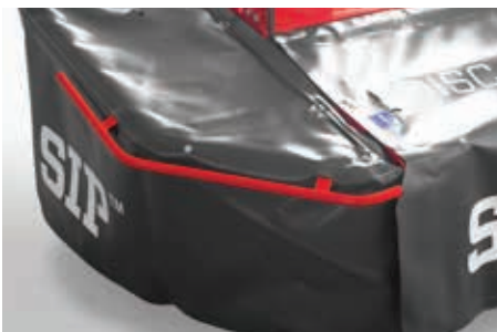
Poręcz zabezpieczająca kurtynę
