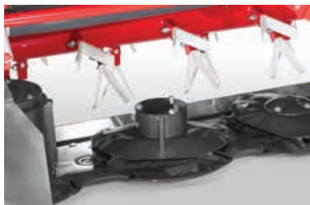
Dolny stożek zapewniający lepszy przepływ masy (H = 65 mm)
