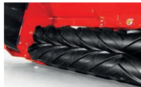
Kondycjoner walcowy gumowy (RRC) umożliwia uzyskanie równomiernie wzdłużne zgniecenie łodygi roślin motylkowych takich jak lucerna czy koniczyna. Nacisk zgniatania jest regulowany.
