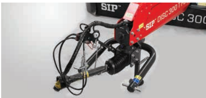
Skrętna przekładnia na zaczepie, którą można obracać o \pm 90^\circ .
