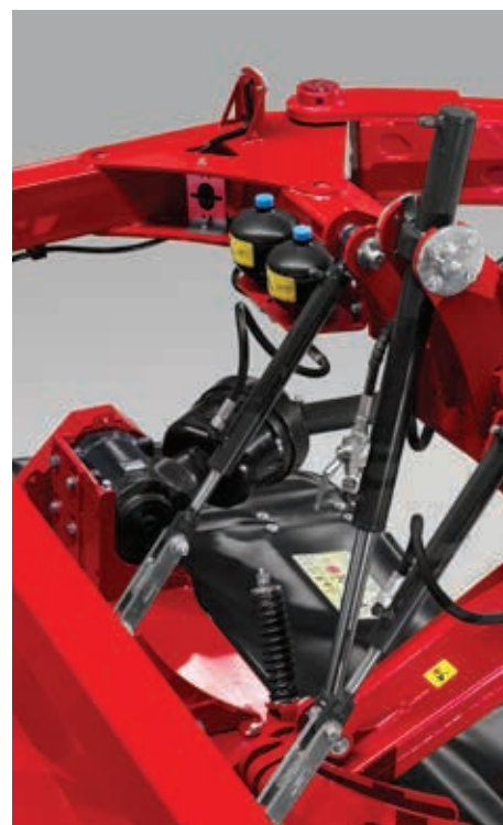
Układ zawieszenia hydro-pneumatycznego (HPS) listwy tnącej zapewnia precyzyjne kopiowanie terenu.
