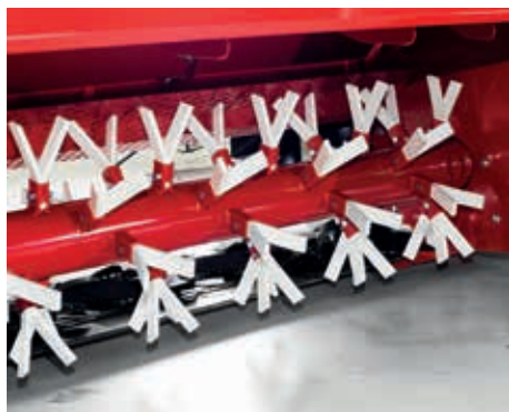
Sztywne plastikowe palce ścierają i uszkodzają warstwę wierzchnią łodyg i liści oraz łamią łodygi.
