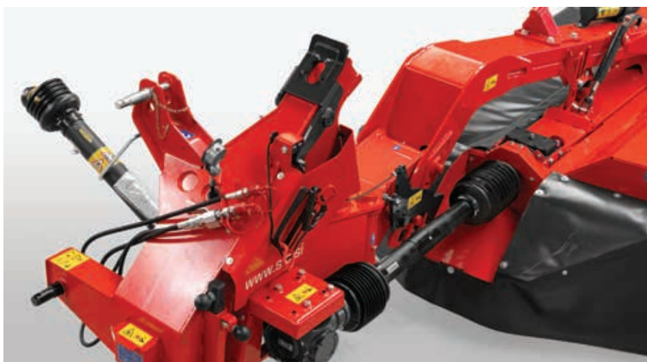
Hydro-pneumatyczne zawieszenie listwy tnącej.
