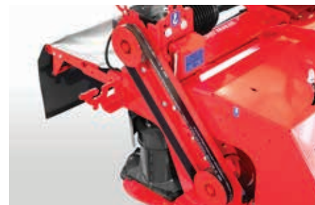
Ograniczenie prędkości obracania palcowego modułu kondycjonującego do 750 obr./min. (brak dostępności dla RRC)
