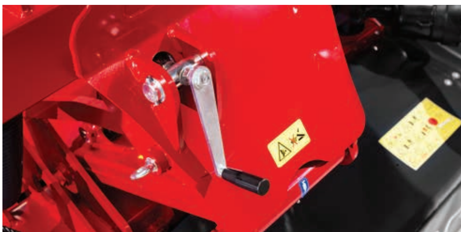
Zaczepek S-FLOW na kosiarkach ciągnionych ma płynną regulację wysokości cięcia.
