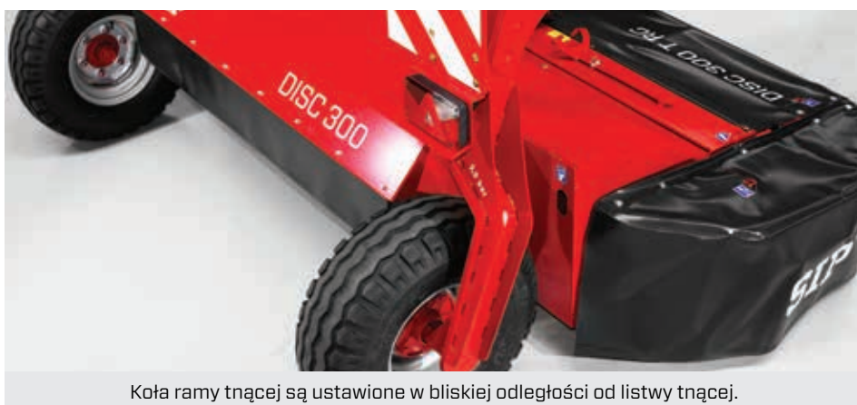
Precyzyjny układ kopiowania terenu listwy tnącej poprzez system zawieszenia S-FLOW.
