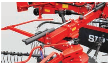
Hydrauliczna regulacja szerokości pokosu (standard w modelu STAR 850|26 T, 1000|30 T)
