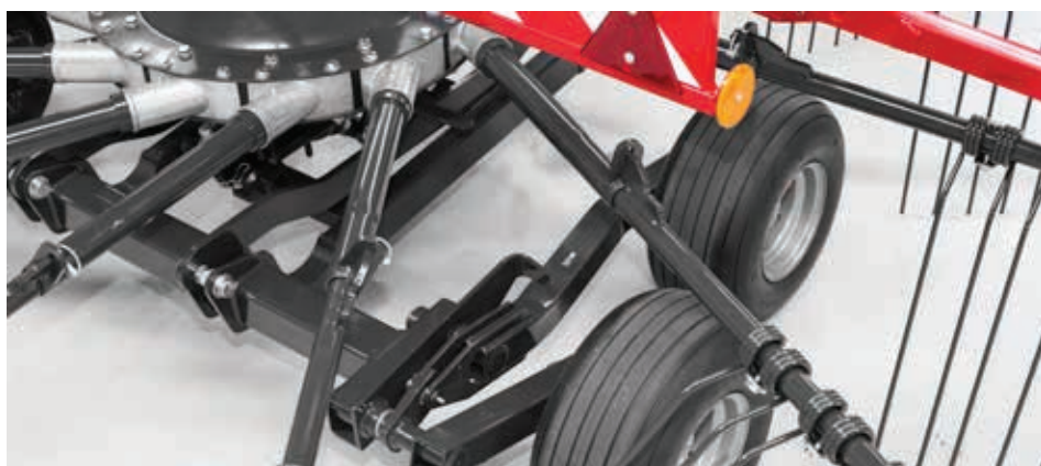
Przednie rotory są wyposażone standardowo w tandemową oś kroczącą firmy SIP (patent firmy SIP), co pozwala na optymalne dostosowanie do terenu, większą prędkość roboczą oraz mniejszy transfer ładunków do maszyny.
