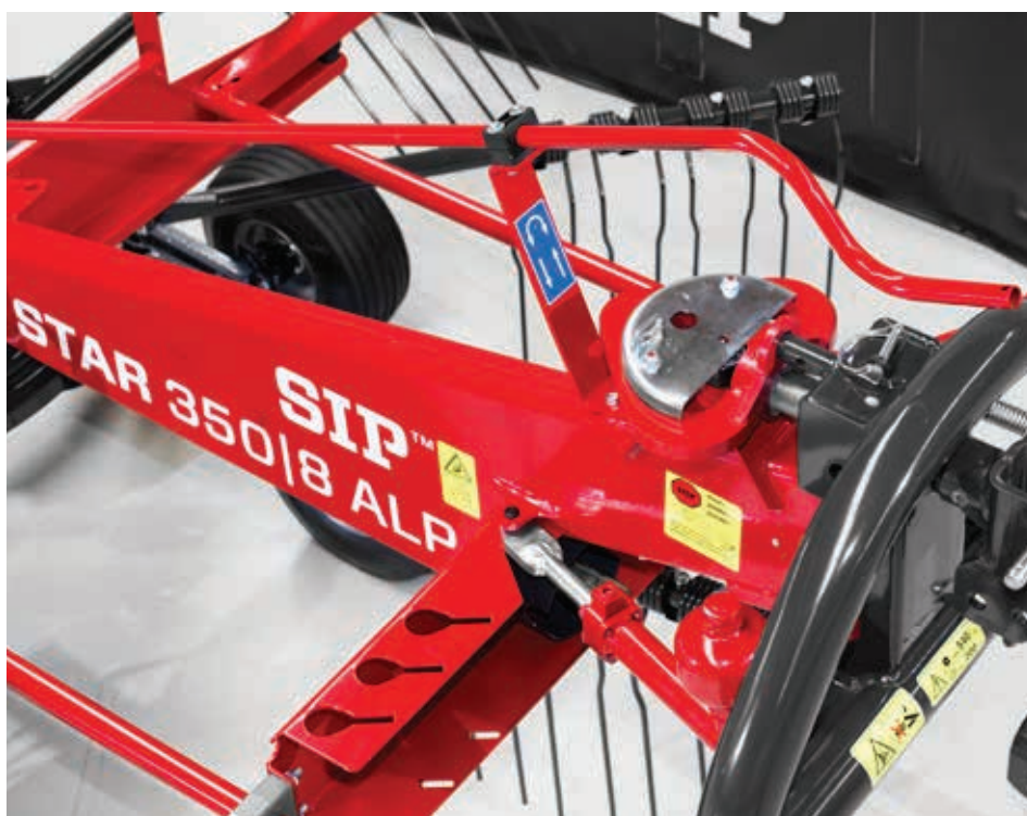
Wysokość roboczą palców sprężynowych można łatwo wyregulować z ciągnika.
