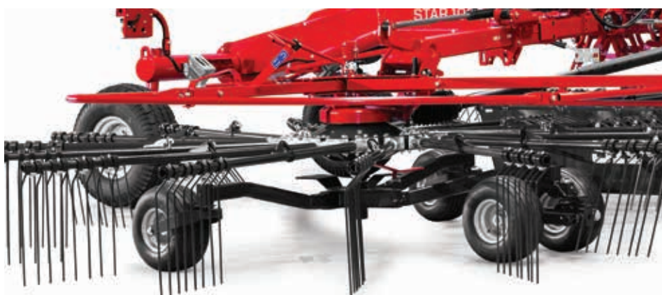
Zawieszenie hydropneumatyczne i mocowanie trójwymiarowe rotorów wraz z tandemową osią kroczącą umożliwia doskonałe dostosowanie do ziemi bez zanieczyszczenia pokosu.
