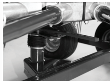
Regulowany tor krzywki \pm 15^\circ w zależności od ilości i wilgotności masy.
