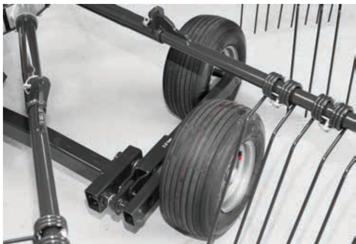
Tandemowa oś krocząca firmy SIP do lepszego kopiowania terenu.
