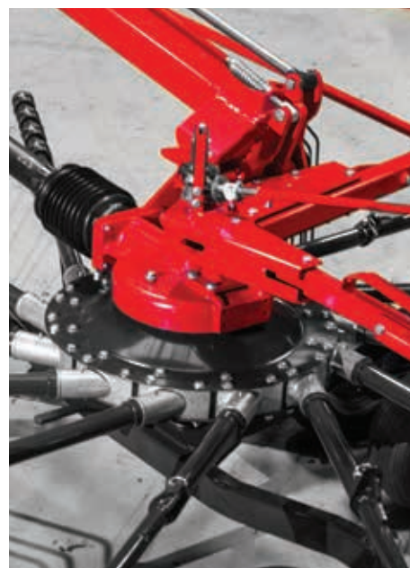
Oba rotory przesuwają się niezależnie od podwozia, zapewniając trójwymiarowe dopasowywanie się na nierównych powierzchniach. Palce sprężynowe pozostają przez cały czas równoległe do gruntu, co zapewnia czyste pokosy wszystkich prędkościach roboczych.
