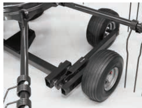
Oś tandemowa krocząca (patent SIP) umożliwia optymalną regulację kąta względem powierzchni terenu, większą prędkość roboczą, mniejsze obciążenie maszyny (STAR 350 | 8 ALP).
