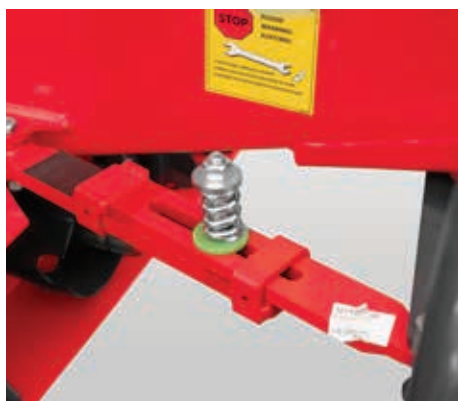
Dodatkowy amortyzator mechaniczny (dostępny dla modeli STAR 320|8 ALP, 350|8 ALP)
