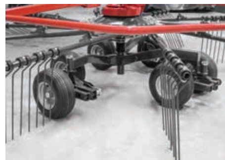
Tandemowa oś krocząca - tylna (dostępna z modelem STAR 700|22 T)
