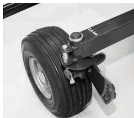
Oś tandemowa krocząca (patent SIP) umożliwia optymalną regulację kąta względem powierzchni terenu, większą prędkość roboczą, mniejsze obciążenie maszyny (STAR 350 | 8 ALP).
