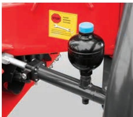
Amortyzator hydrauliczny (dostępny dla modeli STAR 320|8 ALP, 350|8 ALP)
