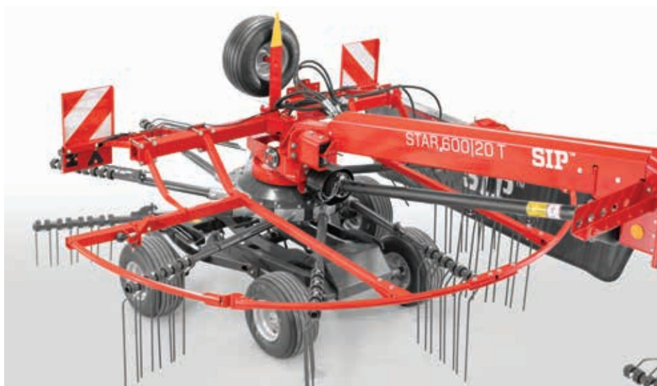
Trójwymiarowe mocowanie skrętne rotora tylnego na podwoziu ramy równoległobocznej pozwala na doskonałe śledzenie gruntu. Rotor tylny jest obsługiwany hydraulicznie, aby zapewnić szybkie i wydajne grabienie.
