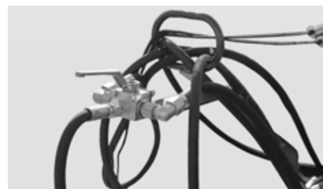
Oddzielne podnoszenie rotorów (standard w modelu STAR 1000|30 T)
