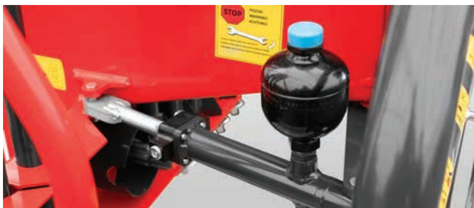
Dodatkowy amortyzator hydrauliczny pozwala na łatwiejsze podążanie za ciągnikiem (opcjonalnie w modelach STAR 320 | 8 ALP, 350 | 8 ALP).
