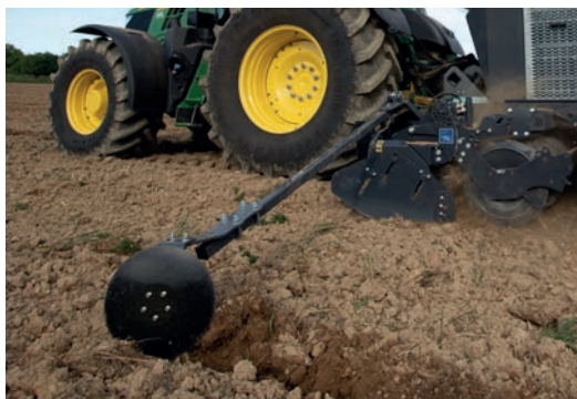
Znaczniki przejazdów montowane na bronie wirnikowej
