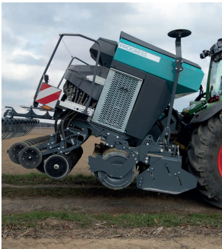
3-ci punkt hydrauliczny do unoszenia sekcji wysiewających
