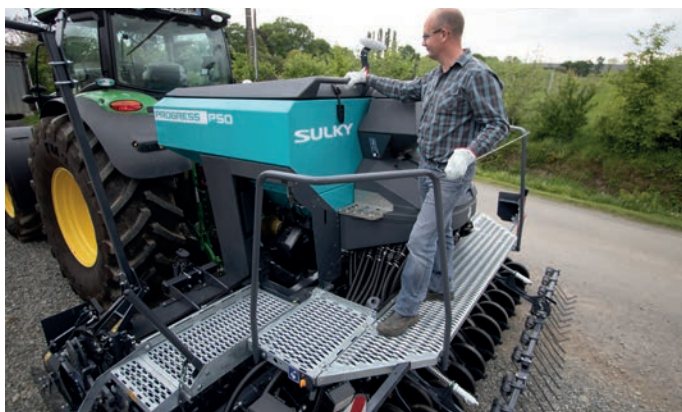
Bezpieczny dostęp do wszystkich funkcji siewnika poprzez szeroki korytarz obwodowy
