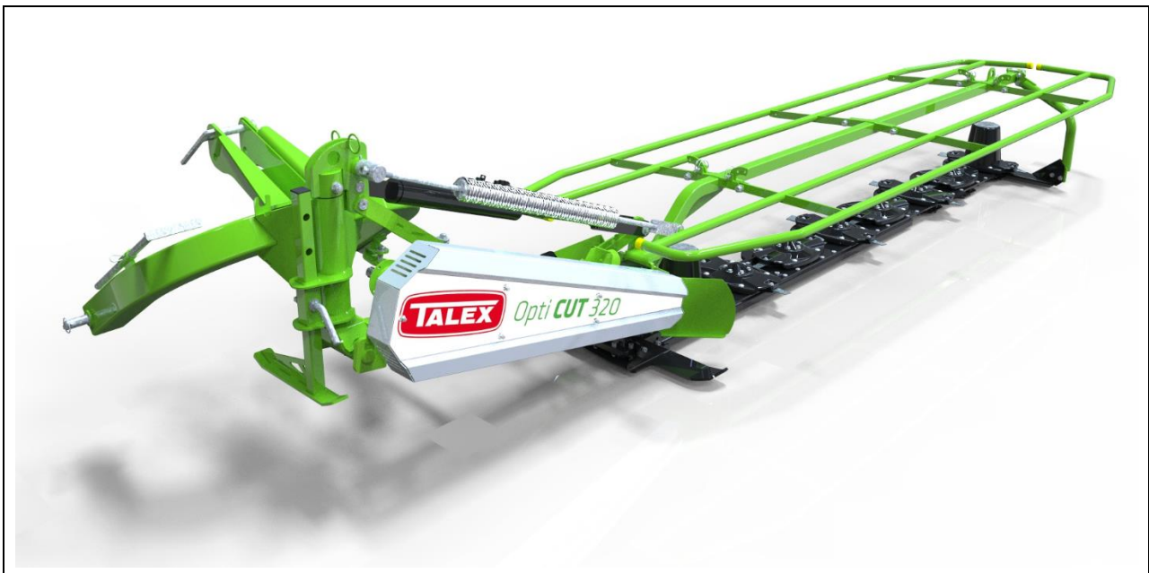
Rys.2 Ogólny widok kosiarki dyskowej (bez osłony brezentowej)
