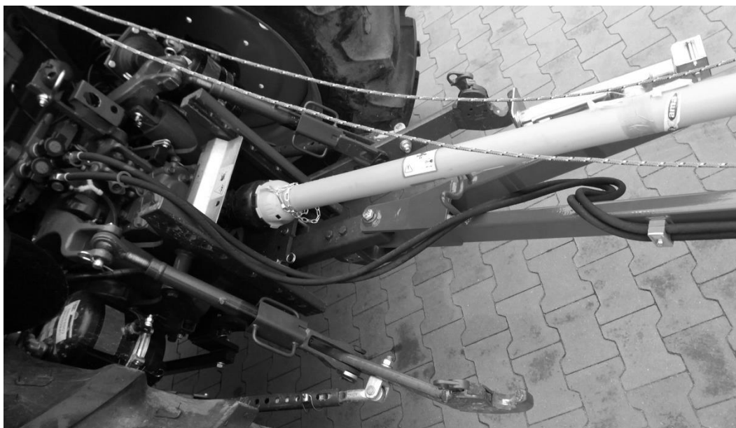
Rysunek 6 Przetrząsacz podłączony do ciągnika
