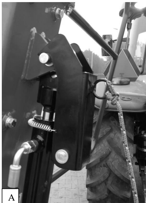
Rysunek 12 Zamknięcie siłownika: A – zamknięte, B – otwarte
