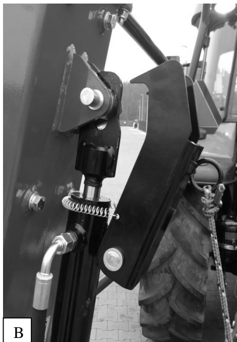
Rysunek 12 Zamknięcie siłownika: A – zamknięte, B – otwarte
