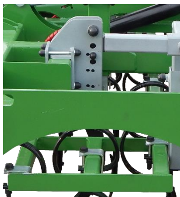
Zdj.6. Regulacja spulchniaczy kół ciągnika
