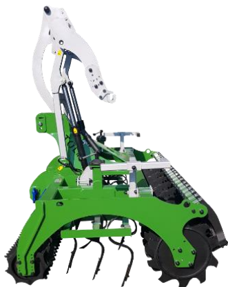
Zdj.3. Hydropak pozycja transportowa i miejsce zabezpieczenia na czas transportu
