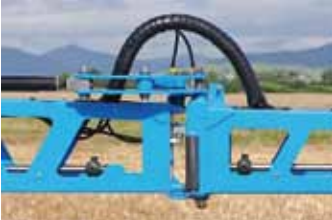
Kaskadowe rozkładanie ramion dzięki stycznikom hydraulicznym
