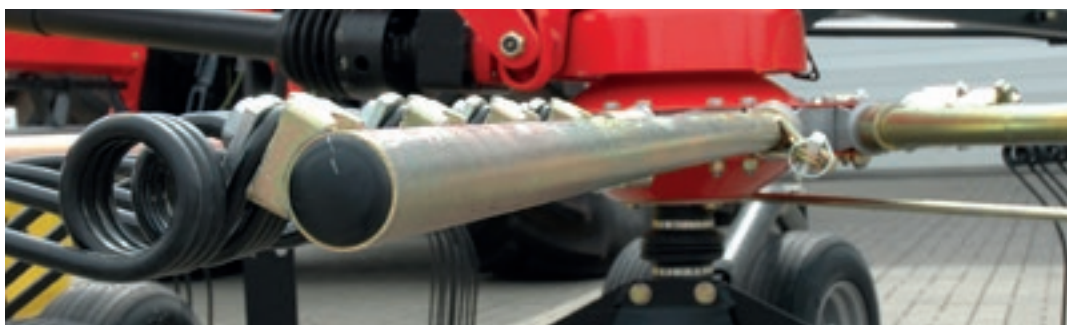
Całkowicie gładka przednia powierzchnia ramienia zębów
