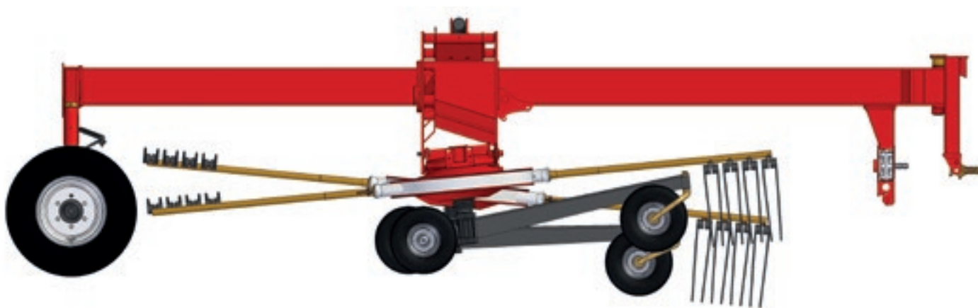
Opatentowane zawieszenie wirników z pełnym zastosowaniem przegubów Kardana
