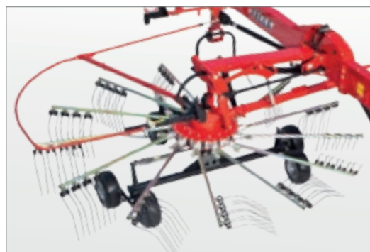
Bezobsługowe łożyskowanie ramion wirników (głowica TS 5)
