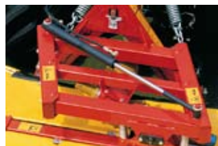
Bezstopniowe, hydrauliczne przesunięcie boczne w modelu FK-S (zawsze 21 cm na prawo i na lewo).
