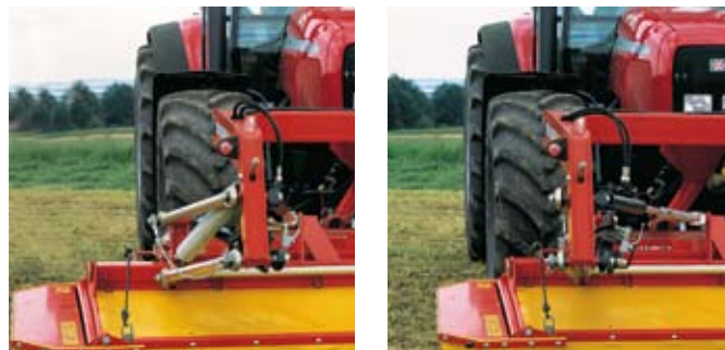
Hydrauliczne przestawienie w bok umożliwia przestawienie maszyny w prawo lub w lewo na odległość ok. 20 cm i jest obsługiwane z kabiny ciągnika. Zaletą tego rozwiązania jest możliwość pracy na stokach i na zboczach (wyposażenie specjalne).
