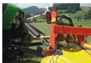
Kompensacja za pomocą sprężyn od strony ciągnika w kierunku punktu przegubu łącznika górnego.
