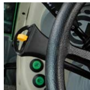
Przełącznik zmiany kierunku jazdy pozwala na łatwą zmianę kierunku jazdy przy użyciu lewej ręki.
