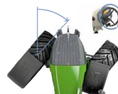
Dzięki układowi kierownicemu VarioActive jeden obrót koła kierownicy wystarcza, by uzyskać maksymalny kąt skrętu.
