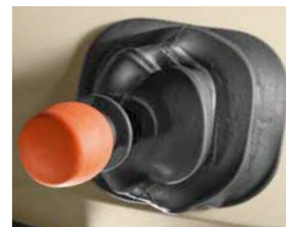
Asystent hamulca ręcznego w położeniu automatycznym: hamulec jest aktywowany automatycznie.
