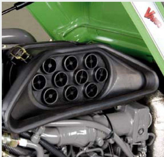
Filtr powietrza z cyklonową częścią wstępną zapewnia maksymalną wydajność oczyszczania, pomimo swych niewielkich rozmiarów w tych kompaktowych ciągnikach.
