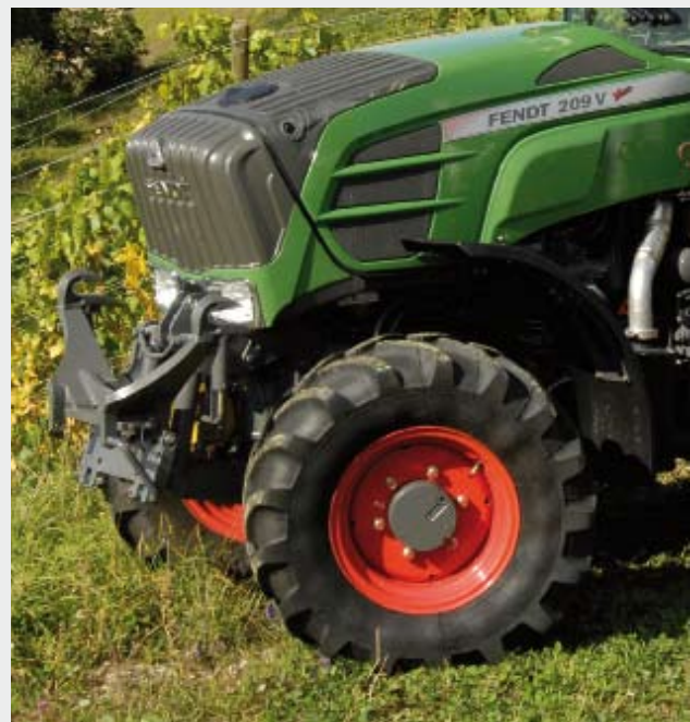
Ramiona dolne przedniego podnośnika są składane bez użycia narzędzi.
