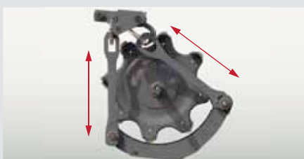
Przednia i tylna odległość klepiska od bębna młocarni regulowane są niezależnie
