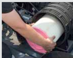
Czyszczenie filtra powietrza
