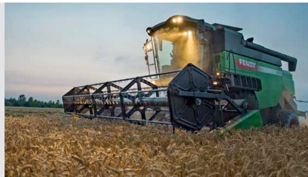
Praca w nocy – górny zestaw oświetlenia Zestaw silnych lamp pozwala sprawnie pracować również po zmroku.
