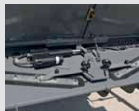
Elektrycznie regulowane kierownice rozdrabniacza
