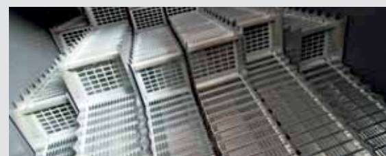
Stopnie wytrząsacza z aktywnymi ścianami tylnymi
