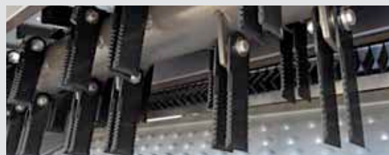
Regulowana w trzech pozycjach płyta rozdrabniacza z profilem ciernym lub gładkim
