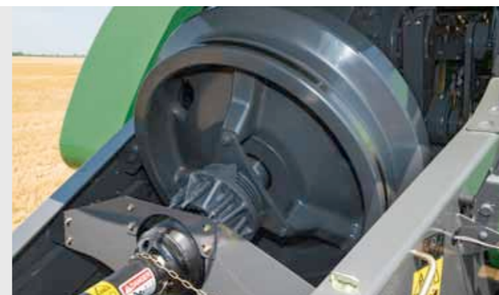
Koło zamachowe waży 545 kilogramu dzięki czemu umożliwia równomierne i sprawne funkcjonowanie, zapewniając jednocześnie wysoki transfer mocy.
