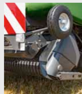
Boczne koła kopiujące chronią podbieracz przed zbyt dużym obniżeniem. Koła mogą być zdjęte do transportu.
