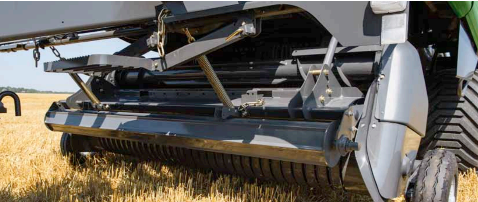
Dodatkowe podajniki ślimakowe dla zapewnienia równomiernego podbierania materiału a przez to dobrze ukształtowanych kostek.
