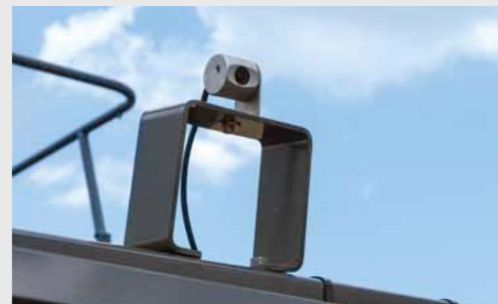
Wstępna instalacja i gniazdo podłączeniowe w terminalu są dostępne standardowo. Dzięki temu mogą Państwo zamocować kamerę video na końcu prasy, aby mieć widok na całą maszynę.
