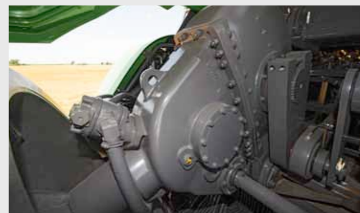
W prasie XD wykorzystywana jest nowa przekładnia o dużej wydajności. Ogólnie rzecz biorąc, przekładnia w prasie XD jest o 35% cięższa od standardowego modelu, może więc generować jeszcze większą siłę zgniotu.
