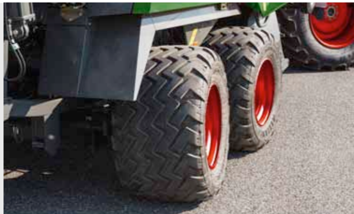
Skrętna oś typu tandem z nowym, opcjonalnym ogumieniem 620 / 40-22.5 gwarantuje dużą powierzchnię kontaktu z glebą i wysoki stopień zwrotności.
