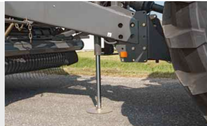
Hydrauliczna stopa podporowa ułatwia przyczepianie prasy do ciągnika i odczepianie jej.
