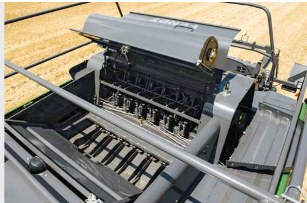
Szeroka pokrywa oraz składana dmuchawa napędzana hydraulicznie gwarantują łatwy dostęp do aparatów wiążących.
