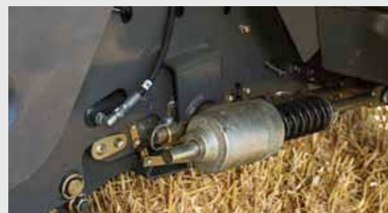
Wysokość ustawienia jest regulowana bez użycia narzędzi, wystarczy unieść podbieracz i przestawić szynę w odpowiedni otwór.
