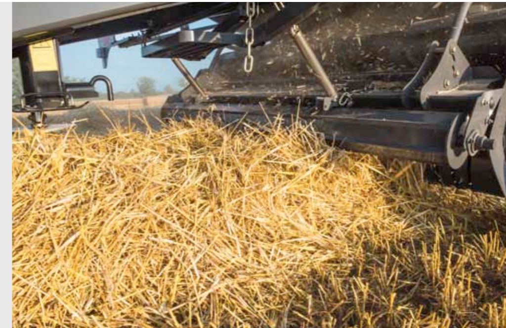
Nowy dociskacz oraz szeroka płaska blacha odbojowa zapewniają równomierny przepływ materiału do prasy.
