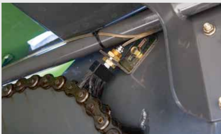
Automatyczne smarowanie dla wszystkich najważniejszych łańcuchów napędowych jest nowością. Okresy smarowania można wygodnie ustawić za pomocą terminalu.
