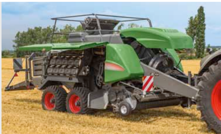
Łatwość konserwacji była głównym celem podczas rozwijania pras kosztujących Fendt. Duże panele boczne o szerokim otwarciu i uszczelniane łożyska samosmarujące znacznie zmniejszają czas wymagany na konserwację.
