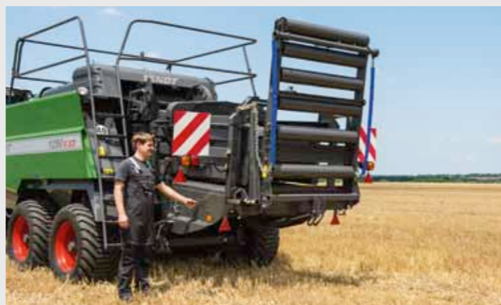
Hydrauliczny wyrzutnik kostek i składana hydraulicznie podłoga zjazdowa dla kostek. Przewrótanie do pozycji transportowej zajmuje tylko kilka chwil.
