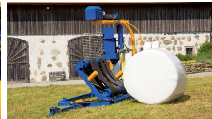
Odkładanie beli następuje przez naciśnięcie przycisku
