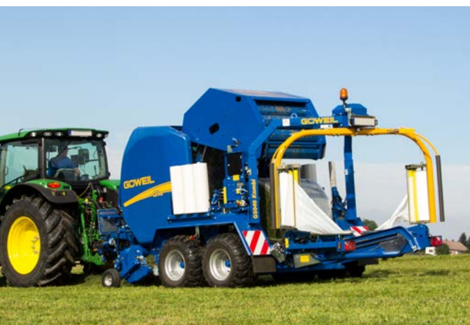
Bela przekazywana jest z prasy na przesuwny stół owijarki.
