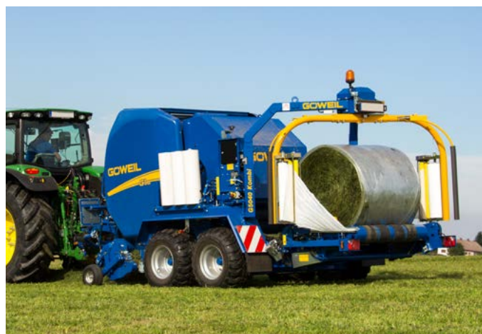
Bela przekazywana jest z prasy na przesuwny stół owijarki.
