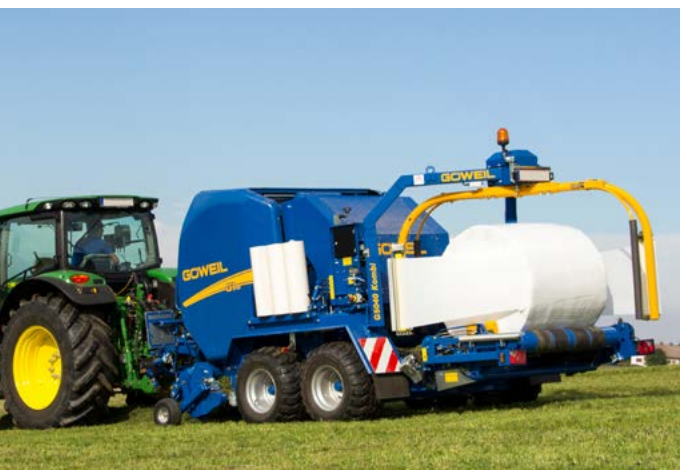
Przy pomocy podwójnego ramienia owijarki bela owijana jest w bardzo krótkim czasie.
