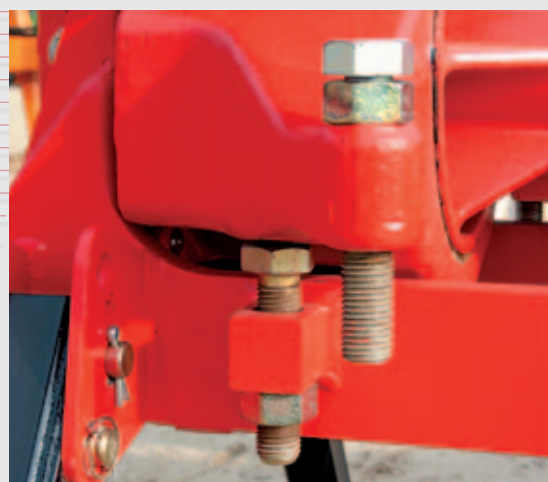
Śruby regulacji pochylenia pługa.
