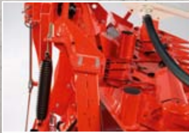
Mechaniczna rama wahadłowa należy włącznie z automatyczną blokadą do transportu drogowego do wyposażenia standardowego.
