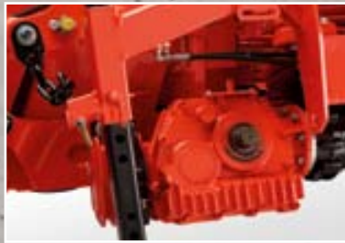
2-stopniowa skrzynia biegów zapewnia optymalną prędkość obrotową, by móc elastycznie reagować na wszystkie warunki oraz pojawiające się długości koszenia w czasie zbiorów.
