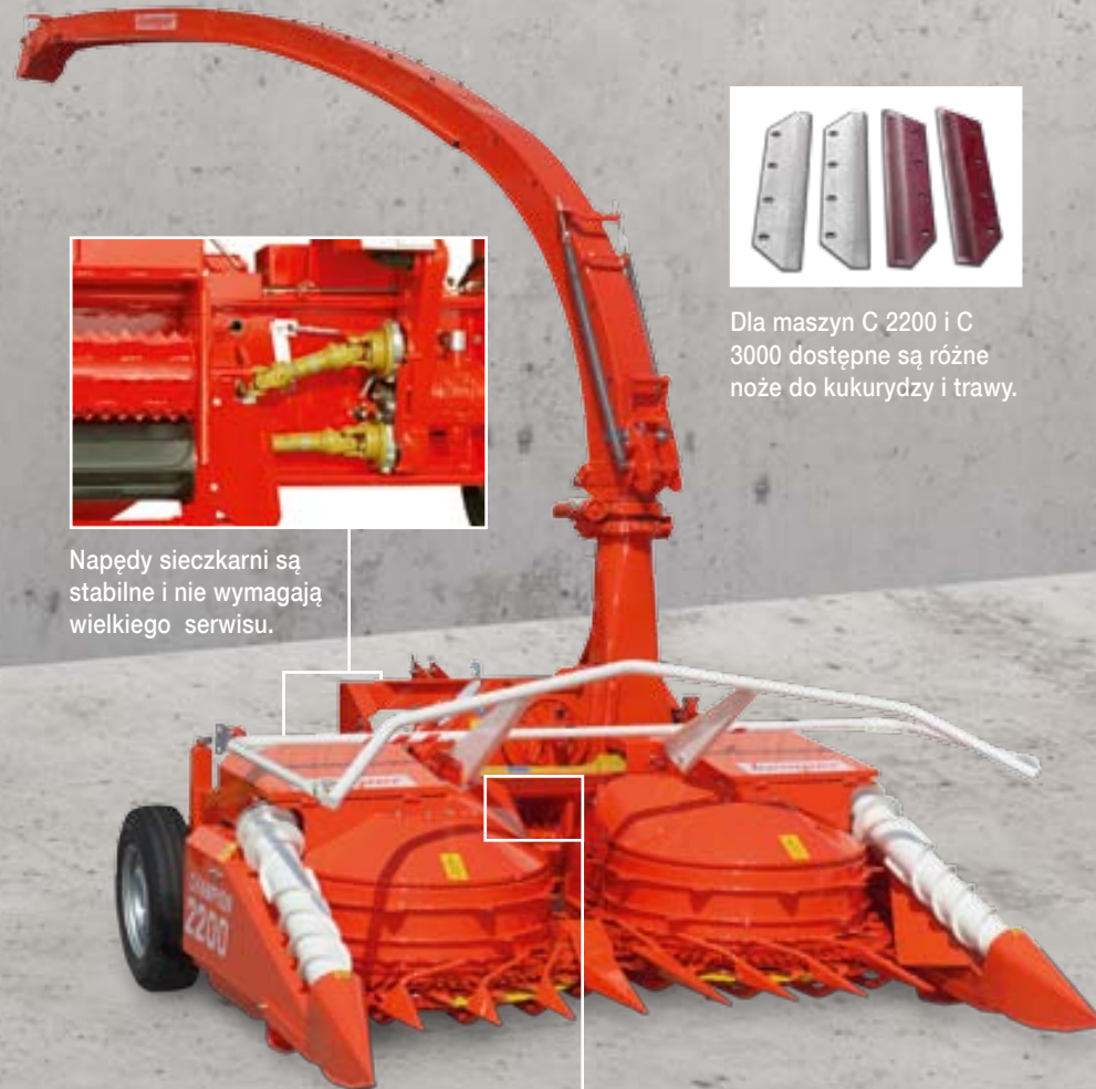
Regulacja długości cięcia (12 długości) przez 4-biegową skrzynię biegów, elektryczny panel sterowania do obsługi z kabiny.
