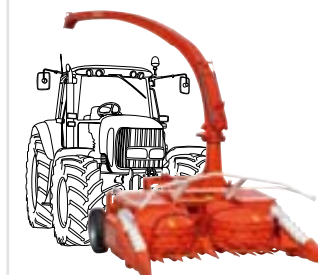
Montaż z przodu z podbieraczem do trawy
