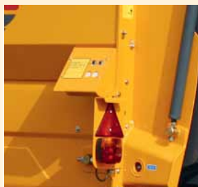
2-gie stanowisko sterujące kłapą załadunkową
