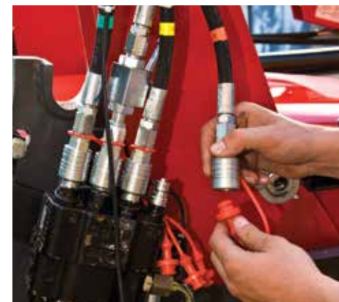
04. Odłączanie połączeń hydraulicznych.
