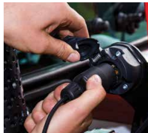
03. Odłączanie połączeń elektrycznych.
