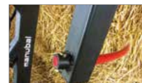
Wyjątkowe mocowanie zębów chwytaka (bez luzu).
