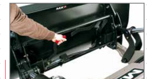
Ramka osprzętu z automatyczną blokadą. Uchwyt odblokowujący dostępny jest z zewnątrz.
