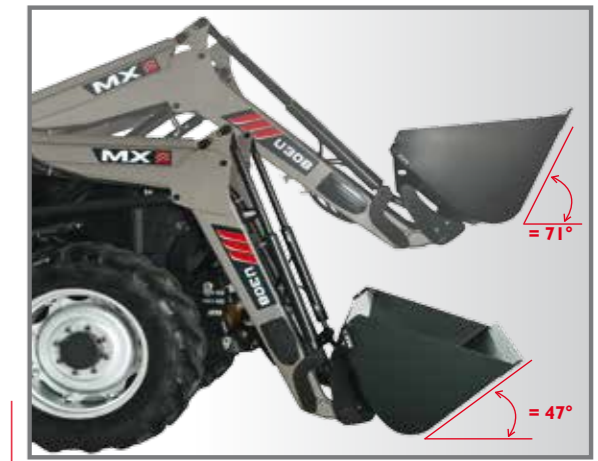
Kąt nabierania zapewnia maksymalną wydajność: aż do 71° na wysokości 1,20 m nad podłożem.
