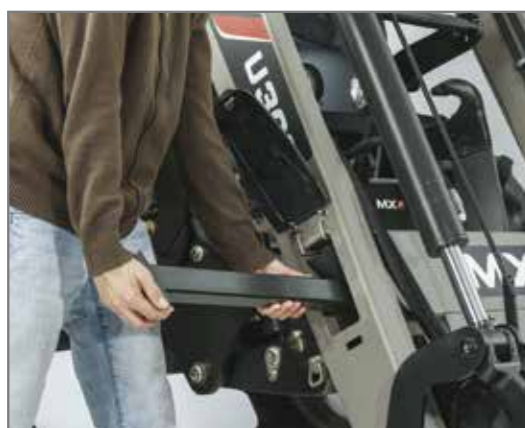
Stopy parkingowe chowane w belce poprzecznej. Zachowana zostaje wysokość podnoszenia
