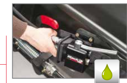
Błyskawiczne podłączanie ładowacz/osprzęt z specjalnymi złączkami w systemie MACH 2.
