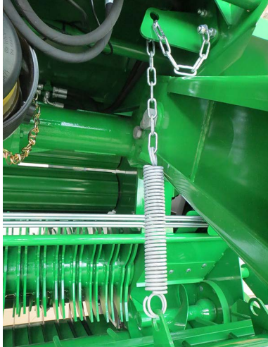
Łańcuch regulujący osłonę uprawy i płyta
