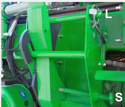
Przechowywanie noży / zaślepek noży
