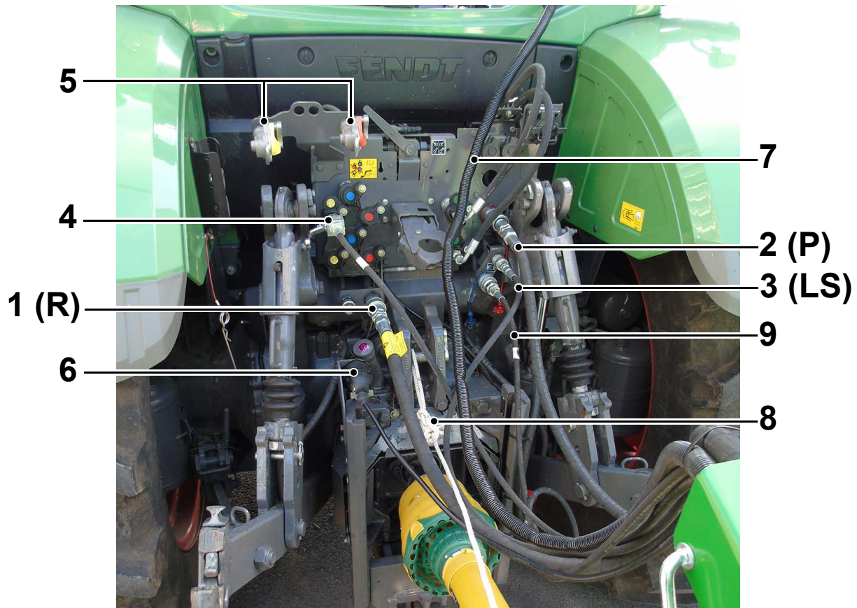
Możliwy układ orurowania hydraulicznego i przewodów elektrycznych
