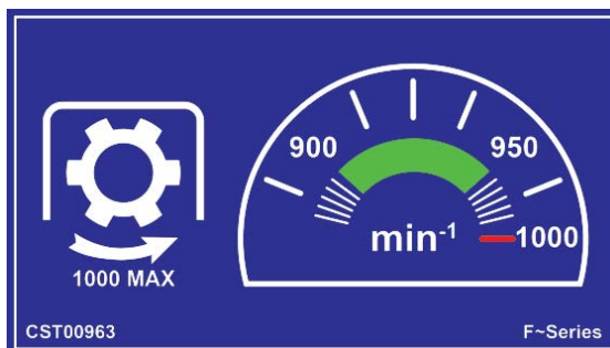
Ustawienie przekładni na 1000 obr./min
