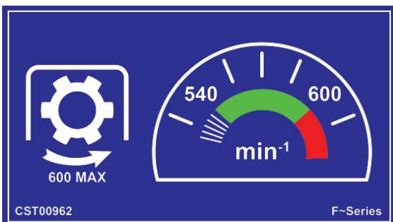
Ustawienie przekładni na 540 obr./min
