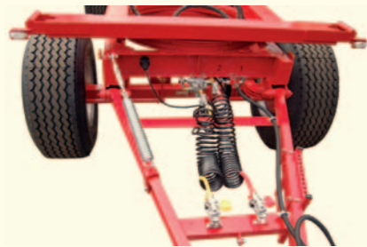
Hamulce przyczep kontrolowane są przez układ automatycznej regulacji siły hamowania oparty na siłownikach membranowych. Przyłączanie do ciągnika poprzez wygodne przewody skrętne.
