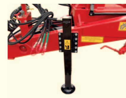
Hydrauliczne dociążenie dyszla
