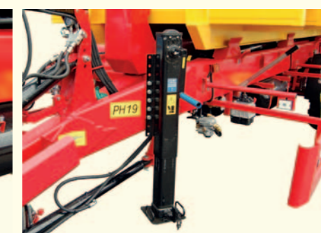
Na życzenie klienta przyczepa może być wyposażona w ręcznie obsługiwaną nogę podporową
