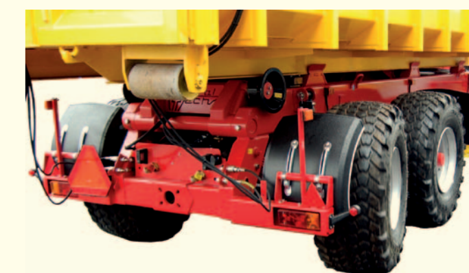
Gniazda hydrauliki do sterowania unoszenia tylnych drzwi kontenera
